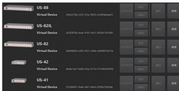
US GUIには、実機が無くても操作を体験できる仮想機器機能が内蔵されており、PCひとつで実際の操作を体験できるようになりました。機種毎に異なる機能も画面上で簡単に確認できることから、導入に先駆けて設定項目や操作感を体験頂くことが可能です。列挙された機器の画像をクリックすると機種情報を掲載したウェブサイトへのジャンプも可能。システム設計時の情報収集活動をも補助する機能が備えられています。
