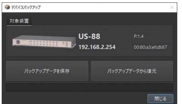
US GUIに搭載された本体設定のバックアップ機能を使えば、システムのバックアップ機器として完全に同じ設定を持つクローナー機器を簡単に作成できます。USシリーズ機器本体には多くの設定項目がありますが、人手で網羅的に同じ設定を作成するのは非常に手間がかかる作業でした。機器の全設定を保存するバックアップ機能により、数クリックで完全に同じ設定を持つ機器の作成を実現します。初期設定から保守管理までを幅広く見据えた機能を網羅する事で安心して導入から運用、保守までをサポートするハードウェアとソフトウェアによるソリューションです。
