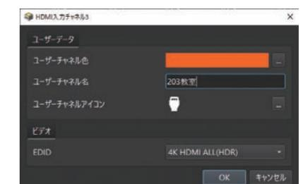
設備に敷設されたスイッチャーでは、チャネルにどのような信号が入力されているのか、チャネルからどのような信号を出力するのか、すぐに分かるような工夫が欠かせません。US GUIでは、接続対象機器毎にユーザーが指定可能なユーザーデータ機能を搭載しました。このユーザーデータ機能は、チャネル名稱やチャネルアイコン、チャネル表示色などを決められます。
