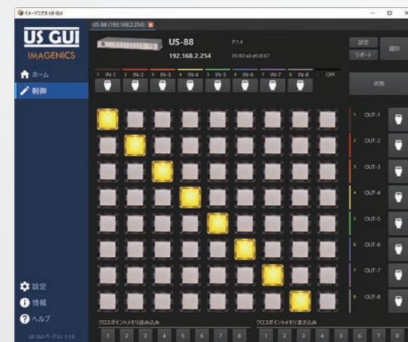
スイッチャークロスポイントの設定画面は、シンプルで見やすい画面デザインを採用。入出力の関係を直感的に把握できる表示系統により、状態把握にかかる時間を大幅に低減します。クロスポイント表示部は、上側に入力チャネル、右側に出力チャネルを配置。ワンクリックで入出力の関係を操作できます。チャネル毎の設定もチャネル名称が表示された箇所のボタンをクリックするだけの簡単操作。豊富な設定項目があるUSシリーズでも操作に戸惑う事はありません。さらに黒基調のユーザーインターフェースを新たにデザイン。敷設設備の機械室や放送設備などの薄暗い環境における操作性を向上させ、安心して実地環境へ導入することが可能です。
