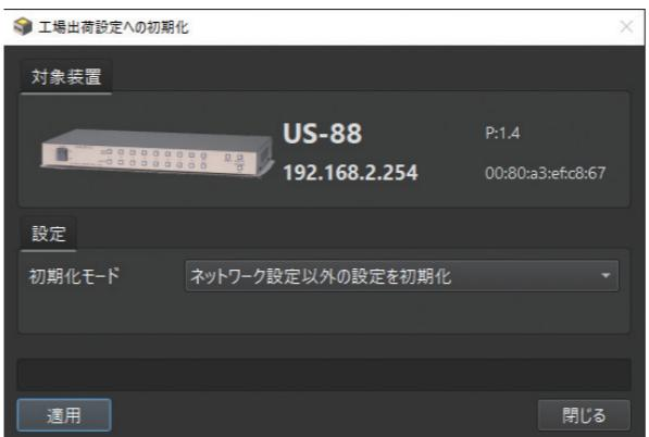
システムに機器を導入する場合、機器を初期状態に戻してから設定を開始する方法が頻繁に用いられます。US GUIには、このようなワークフローをサポートするための工場出荷設定への初期化機能を搭載。システムのセットアップの手間を低減します。
