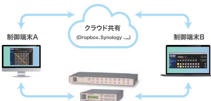
アプリケーションデータには、機器設定バックアップ情報、ユーザーデータなどが格納され、ユーザーの操作を補助します。アプリケーションデータをクラウドファイル共有サービスで連携することにより、アプリケーションデータを端末間で共有することを可能にしました。
