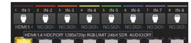
スイッチャーに入力された信号の状態や、出力される信号の状態を知る事は非常に重要です。特に沢山の信号が入出力される現場では、信号が期待通りに正しく入力されているのか知りたいもの。US GUIの制御画面にある状態ボタンは、入出力信号の状態を検知する機能を備えており、ワンクリックで即座に入出力信号状態を確認できるようになりました。
