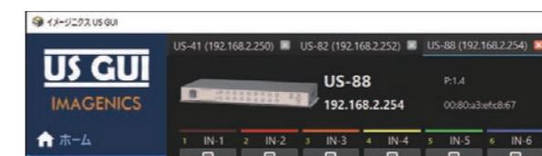
様々な機器を組み合わせてシステムを構成する場合、対象システム内で複数のスイッチャーが配置されます。US GUIは1つのアプリケーションで複数のUSシリーズ機器に同時接続ができます。制御対象の切り替えはショートカットキーを使った操作が可能で、これまでにない敏速な操作環境を御提供します。別々のウィンドウに表示したい場合には、US GUIを複数起動する事も可能。様々な使い方が可能な柔軟性のある運用環境を実現します。
