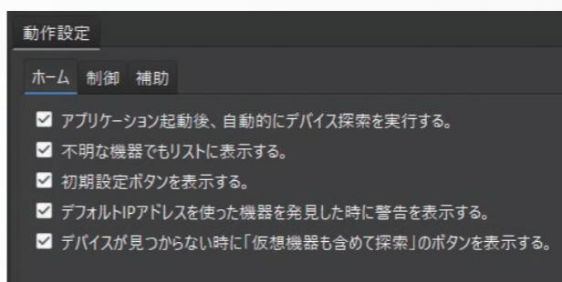
US GUIは、初期設定から運用、保守までを包括的にサポートする各種機能が搭載されていますが、場面に応じた機能調整も欠かせません。US GUIの設定画面には、運用場面に応じた設定を可能にするきめ細かな設定項目を用意しました。初期設定には初期設定に適した動作、運用には運用に適した動作を選択することができ、場面に応じた最適な操作環境を提供します。
