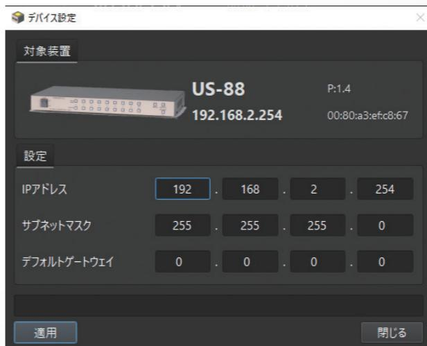
機器の初期設定時に必ず必要になるネットワーク設定も見やすいユーザーインターフェースで簡単に実現。設定対象の機器外観とIPアドレス、ファームウェアバージョンやMACアドレスなども併せて表示されるため、設定時の確認作業負荷を低減します。ネットワーク設定時に起こりがちなIPアドレス衝突回避のための警告機能も搭載。同じネットワーク上に衝突の可能性のあるUS機器を発見した場合には、設定反映前に警告を行ないます。慌ただしいシステム設定の現場でも安心してお使い頂ける設定環境です。
