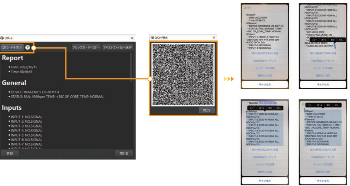
機器の概況を即座に確認したい場合、リポート情報の表示が便利です。機器の状態を的確に把握し、必要に応じて外部と共有する事で機器がシステムの中で適切に動作しているか確認する際に役立ちます。QRコードを使ったテキスト情報共有機能も搭載し、携帯端末による情報管理にも対応。USBデバイスなどの接続が難しいミッションクリティカルな運用現場での的確な情報収集作業を可能にします。現場サポートの負荷を大幅に低減する便利な機能が搭載されています。
